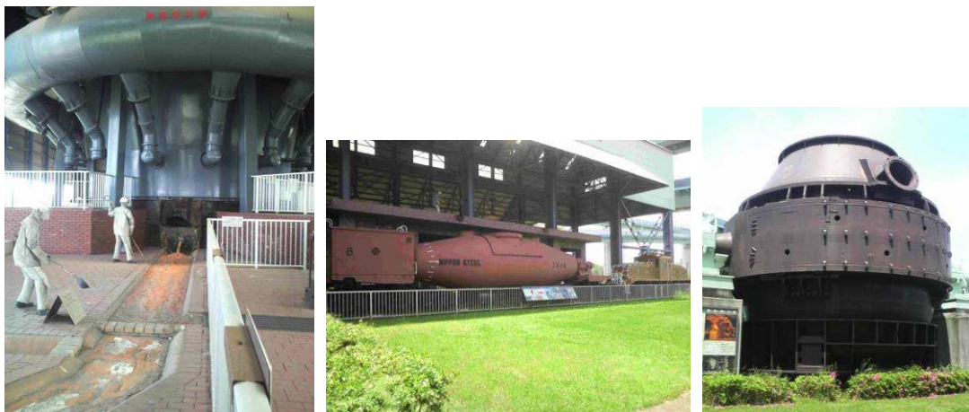
図5. 東田第一高炉内部施設 左：出銑口とそこでの作業の様子 中：トープードカー 右：転炉 (写真は東田第一高炉跡広場にて筆者が撮影)
